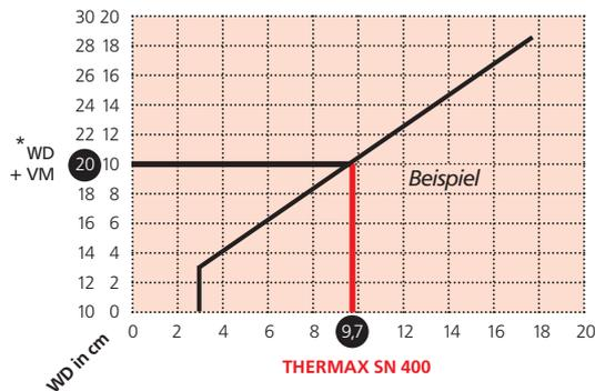
Arbeitsdiagramm zur Bestimmung der Dämmschichtdicke von THERMAX SN 400 für den Einsatz nach Fachregeln des Kachelofen- und Luftheizungsbauphandwerks als Ersatz für Vormauerung (VM) und Wärmedämmung (WD) nach AGI Q 132.
