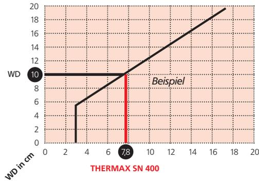
Arbeitsdiagramm zur Bestimmung der Dämmschichtdicke von THERMAX SN 400 für den Einsatz nach Fachregeln des Kachelofen- und Luftheizungsbauphandwerks als Ersatz für Wärmedämmung (WD) nach AGI Q 132.
