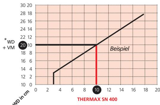
Arbeitsdiagramm zur Bestimmung der Dämmschichtdicke für den Einsatz nach DIN 18895 T1 als Ersatz für Vormauerung (VM) und Wärmedämmung (WD).
