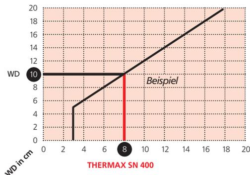
Arbeitsdiagramm zur Bestimmung der Dämmschichtdicke für den Einsatz nach DIN 18895 T1 als Ersatz für Wärmedämmung (WD).
