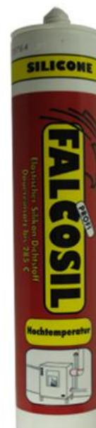
**Beschreibung:** Einkomponenten Silikon-Dichtmasse auf Acetat-Basis, die unter Einfluss von Luftfeuchtigkeit zu einer gummielastischen Masse reagiert. Diese ist temperaturbeständig bis + 285° C, kurzzeitig bis + 300° C, dauerelastisch, alterungs- und UV-beständig, haftet auf vielen Untergründen.
