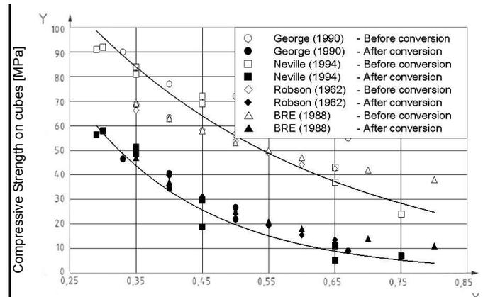
Für Anwendungen am Bau wird empfohlen, einen Mindest-Zementanteil von  $400 \text{ kg/m}^3$  Ciment Fondu® mit einem Wasser/Zement Verhältnis von  $\leq 0.40$  zu verwenden.
